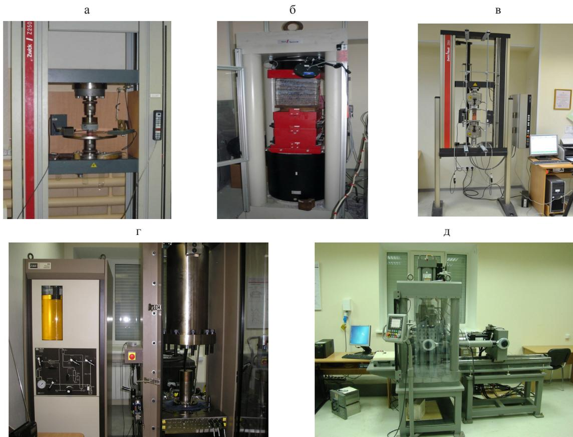
Рисунок 1 – Проведение испытаний горных пород: а – электромеханический пресс Zwick/Z250; б – гидравлический пресс ToniNORM 2041; в – электромеханическая универсальная испытательная машина Zwick/050; г – стабилометрический испытательный комплекс MTS-815; д – сдвиговой испытательный комплекс MTS-816
