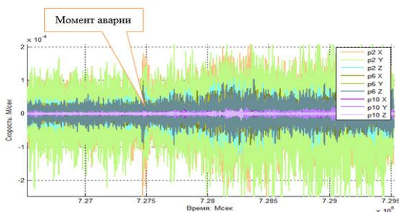
Рисунок 7 – Запись аварии во второй, шестой и десятой точках плотины по трем составляющим
