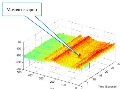
Рисунок 11 – Спектрограмма записи аварии в трёхмерном изображении
