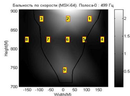
Рисунок 8 – Распределение интенсивности колебаний по телу плотины
