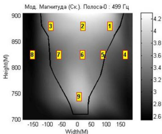
Рисунок 9 – Распределение спектральной магнитуды Мд по телу плотины
