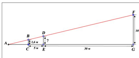
Рисунок 6 – Определение высоты дерева
