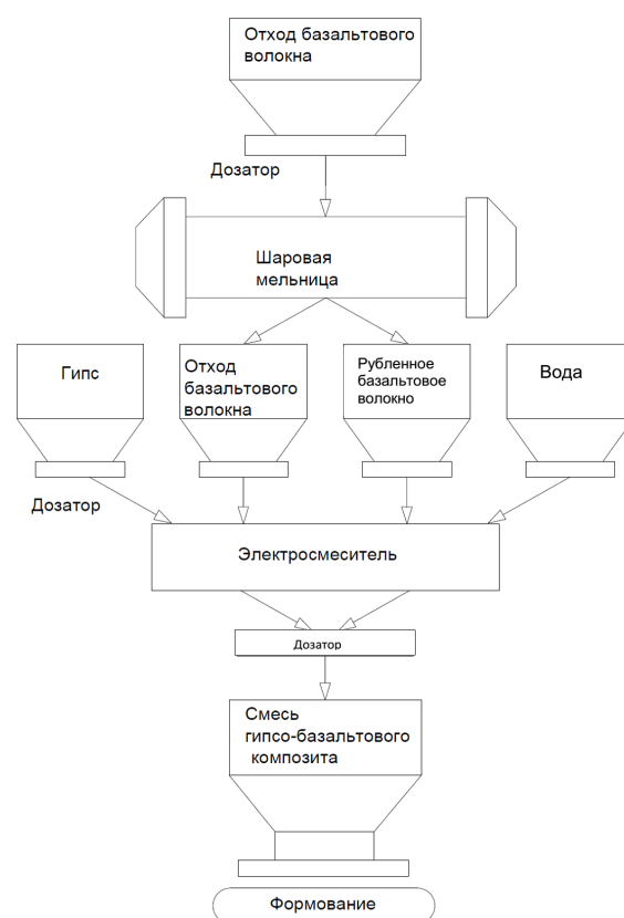
Рисунок 3 – Технологическая схема получения гипсо-базальтового композита
