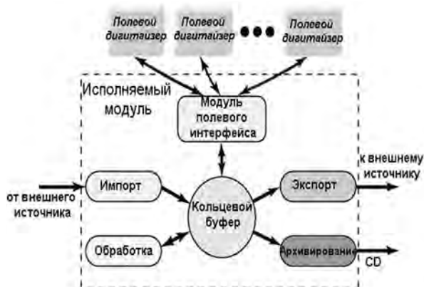
Рисунок 7 – Система Antelope передачи потока данных в режиме реального времени
