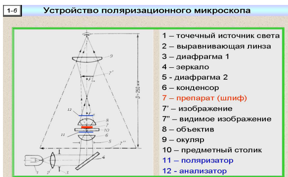
Рисунок 2 – Оптическая схема поляризационного микроскопа:
