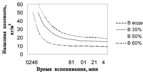
Рисунок 5 – Зависимость насыпной плотности пенополистирола от времени вспенивания в водных растворах различной концентрации
