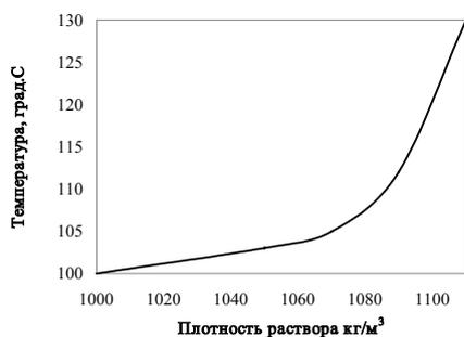
Рисунок 4 – Зависимость температуры кипения водных растворов этиленгликоля от их плотности
