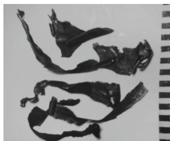
Рисунок 3 – Характер разрушения стальных труб от взрыва различных НВС
