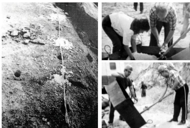
Рисунок 7 – Подготовка взрывчатых составов, заряды в шпурах и результаты взрыва состава плотностью 0,015 г/см<sup>3</sup> (слева) и плотностью 0,005 г/см<sup>3</sup> (справа) в розовом граните
