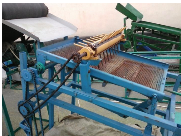
Рисунок 2 – Экспериментальная установка, состоящая из ленточного транспортера и сепаратора листовой части трав с подбрасывающим барабаном
