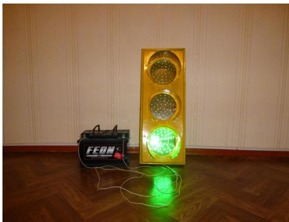
Рисунок 1 – Светофор, питаемый от автомобильной аккумуляторной батареи
