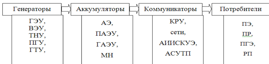
Рисунок 1 – Ориентировочный состав элементов ГЭК: ГЭУ – гидроэнергетические установки, ВЭУ – ветроэнергетические установки, ТНУ – тепло-насосные установки, ПГУ – парогазовые установки, ГТУ – газотурбинные установки, АЭ – аккумуляторы электрохимические, ПАЭУ – пневмоаккумулирующие энергетические установки, ГАЭУ – гидроаккумулирующие энергетические установки, МН – механические накопители, КРУ – комплектные распределительные устройства, АИИСКУЭ – автоматизированная информационно-измерительная система коммерческого учета электроэнергии, АСУ ТП – автоматизированная система технологического управления, ПЭ – потребители энергии, ПР – потребители-регуляторы, ПГЭ – потребители гарантированного энергоснабжения, РП – резервные потребители
