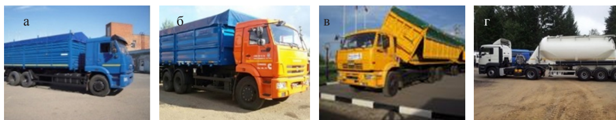
Рисунок 3 – Подвижной состав, применяемый для перевозки зерновых: а – бортовые зерновозы; б – автопоезда бортового типа; в – автопоезда самосвального типа; г – автоцистерны-зерновоза
