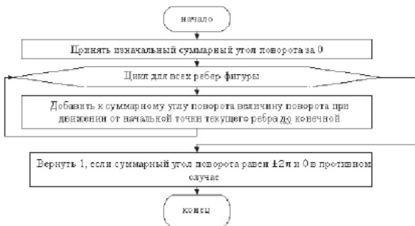
Рис. 1. Блок-схема работы алгоритма оконтуривания по методу 2
