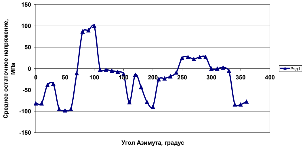
Рис. 12. График среднего остаточного напряжения по кругу образца филлита хлорит-серицитового (Кумтор, скв. Д794, глуб. 27,9–28,7 м, диаметр обр. 60 мм, высота 170 мм)
