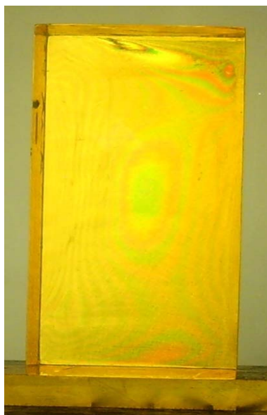
Рис. 7. Образец №9 с плоскополяризованным остаточным напряжением (перпендикулярная к плоскости поляризации сторона ВС).
