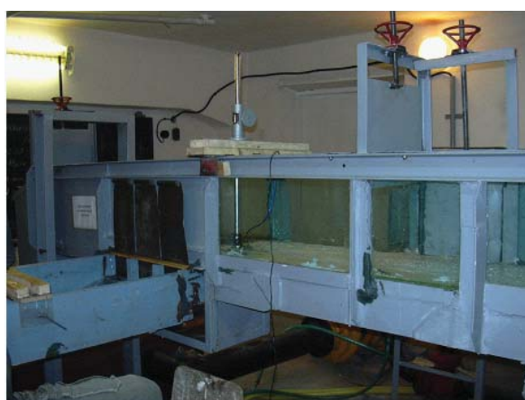
Рис. 4. Гидравлический лабораторный лоток в лаборатории кафедры ГТСиВР КPCSU.
