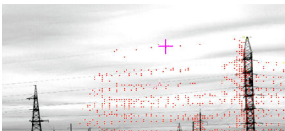
Рисунок 3 – Пример обнаружения опор и проводов ЛЭП, используемой лазерной системой
