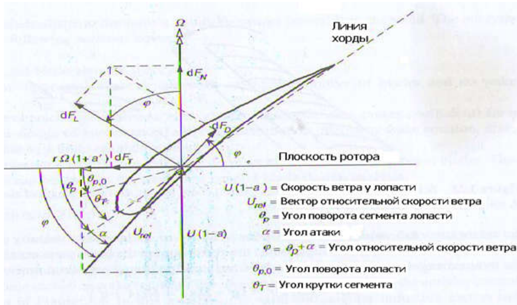
Рисунок 3 – Геометрия лопасти
