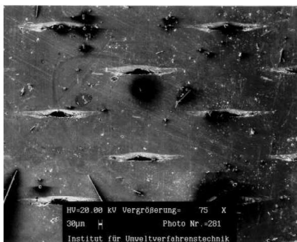
Рисунок 2 – Микрофотография поверхности перфорированной металлической фильтровальной перегородки
