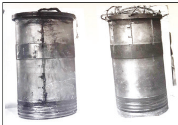
Рисунок 3 – Общий вид втулок цилиндра с установленными термодарами
