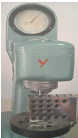
Рисунок 1 – Измерение твердости обработанной сверлением поверхности
