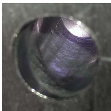
Рисунок 13 – Качество обработанных поверхностей: 1 – сверлом с конической заточкой; 2 – сверлом с двухплоскостной заточкой
