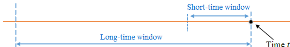
Рисунок 1 – Относительное расположение окон с выравниванием по правому краю, означающее, что точка, для которой вычисляется отношение STA / LTA, находится на крайнем правом крае
