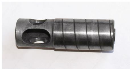
Рисунок 3 – Рабочая поверхность поршня регулятора с эмульгатором 6СФК-180-0,5
