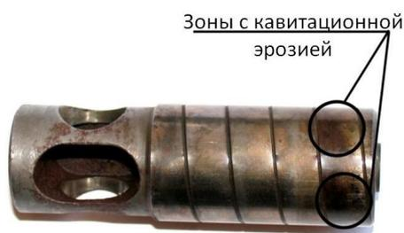
Рисунок 2 – Рабочая поверхность поршня регулятора с кавитационной эрозией
