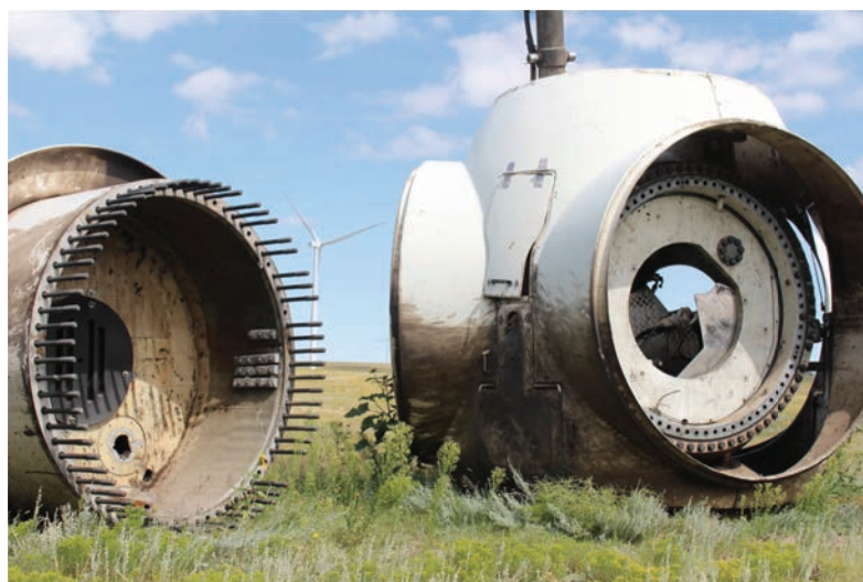
Рисунок 4 – Старые ступицы ветряных турбин, которые будут отправлены на металлолом
