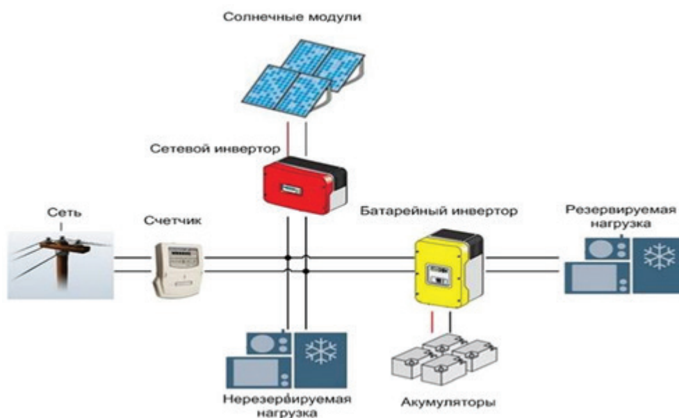
Рисунок 4 – Фотоэлектрическая установка с дублирующим источником энергии из сети
