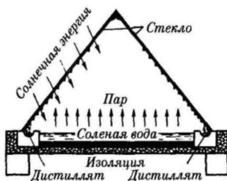
Рисунок 7 – Схема вида солнечной опреснительной установки
