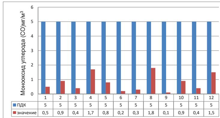
Рисунок 8 – Результаты замеров монооксида углерода (CO), мг/м<sup>3</sup>
