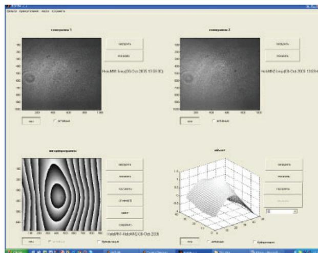
Рисунок 8 – Результат расчета поля абсолютных перемещений
