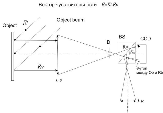
Рисунок 1 – Оптическая схема записи цифровой голограммы сфокусированного изображения
