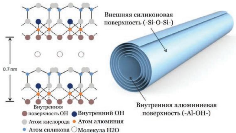
Рисунок 3 – Схема строения галлуазитовой нанотрубки [17]
