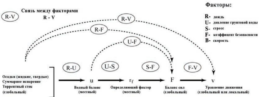
Рисунок 2 – Схема обоснованной модели возникновения и развития оползня
