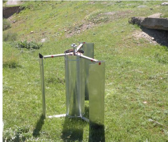
Рисунок 7 – Фрагмент узла вращающегося цилиндра с приводами подъемной силы Жуковского
