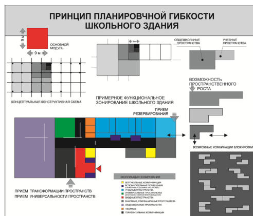
Рисунок 3 – Принцип планировочной гибкости школьного здания
