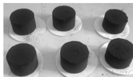
Рисунок 2 – Брикетки из кожокеленского угля с порошком эремуруса и бентонитовой глины
