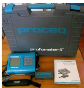
Рисунок 6 – Прибор неразрушающего контроля PROCEQ "PROFOMETER5+" для определения армирования ж/б конструкций и толщины защитного слоя бетона
