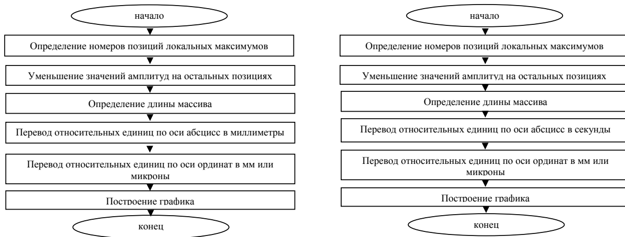
Рисунок 5 – Блок-схемы программ построения графиков обнаруженных дефектов в зависимости от выбранного значения размерности по оси абсцисс
