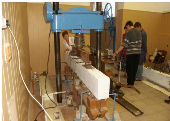
Фото 4 – Испытания перемычек из фибропеножелезобетона
