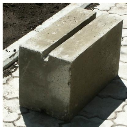
Фото 3 – Блоки из безавтоклавного ФПБ со средней плотностью 400 кг/м<sup>3</sup>
