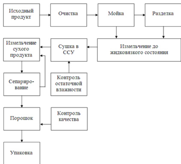
Рисунок 1 – Блок-схема технологии получения порошка сельхозпродуктов с помощью солнечной энергии
