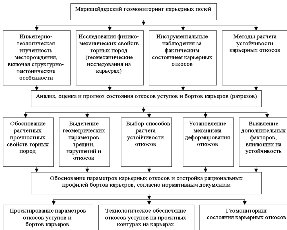
Рисунок 3 – Структурная схема организации геомониторинга прибортовых массивов карьеров
