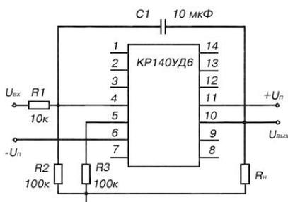
Рисунок 5 – Типовая схема включения КР140 УД6
