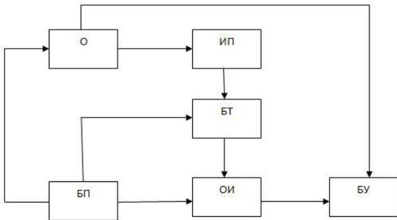
Рисунок 1 – Блок-схема стенда для научных исследований алгоритмических методов повышения точности измерений: О – оператор; ИП – измерительный прибор; БТ – блок тестов; ОИ – объект исследования; БУ – блок управления; БП – блок питания
