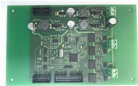
Рисунок 2 – Электронный модуль управления линейного привода
