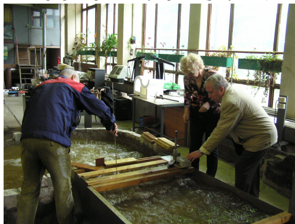
Рисунок 2 – Гидравлические исследования дополнительного туннельного водосброса Майнской ГЭС
