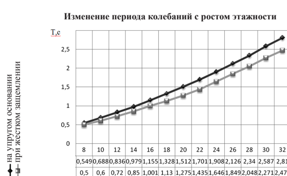
Рисунок 6 – Зависимость периода колебаний от этажности здания
