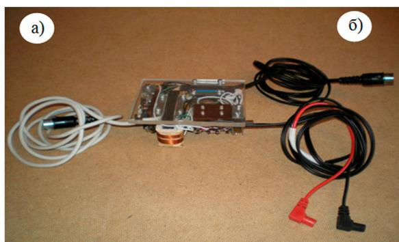
Рисунок 1 – Внешний вид магнитоупругого тестера:
