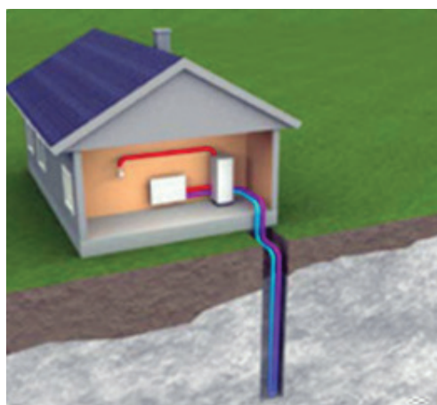
Рисунок 3 – Замкнутая система использования низкопотенциальной тепловой энергии Земли: а – вертикальная; б – установка кластерного геотермального поля
