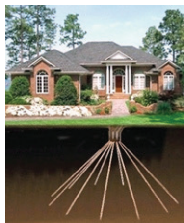
Рисунок 3 – Замкнутая система использования низкопотенциальной тепловой энергии Земли: а – вертикальная; б – установка кластерного геотермального поля
