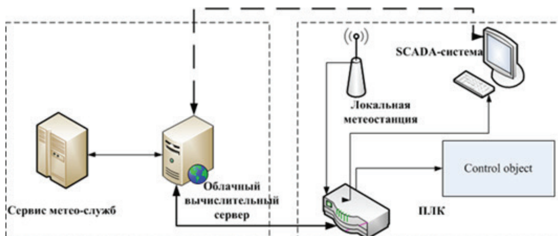
Рисунок 1 – Структура многоуровневой САУ с применением облачного вычислительного сервера
