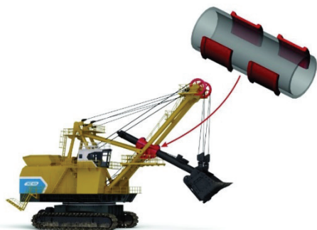
Рисунок 2 – Карьерный экскаватор типа ЭКГ и его седловой подшипник
