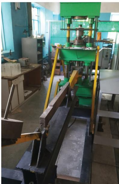
Рисунок 1 – Общий вид рычажного пресса
