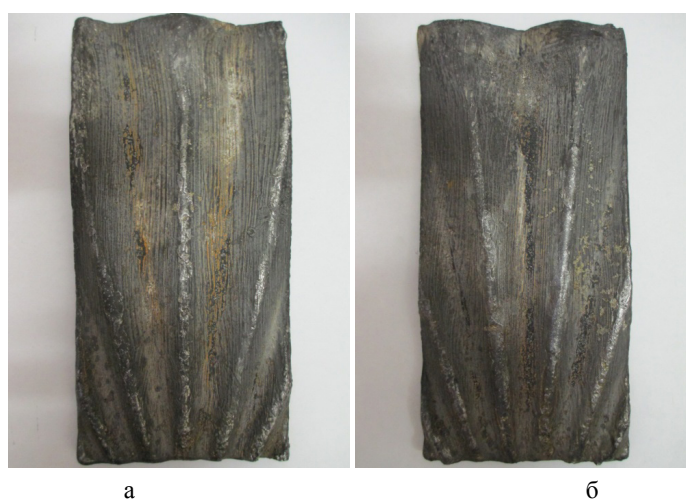
Рисунок 6 – Дробящие плиты с переменными рифлениями а – подвижная; б – неподвижная
