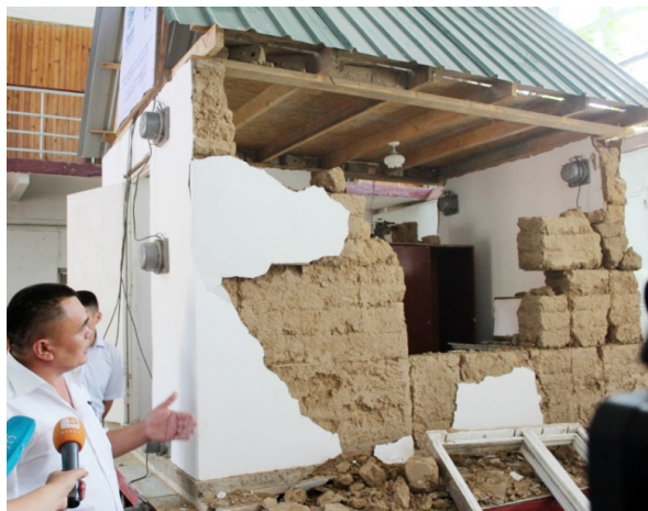
Рисунок 4 – Общий вид модели дома из “сокмо” после эксперимента
