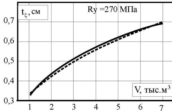
Рисунок 1 – Зависимость усредненной толщины стенки от объема: ..... – согласно [2]; — по формуле (6)
