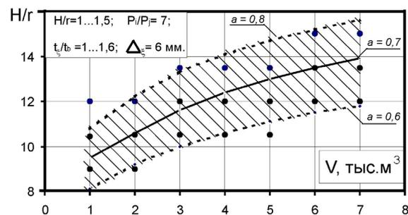
Рисунок 2 – Зависимость оптимальной высоты стенки от объема:
