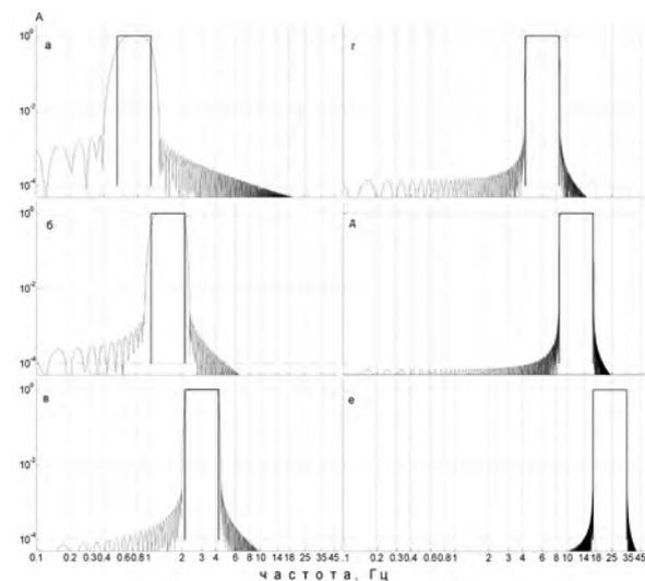
Рисунок 3 – АЧХ цифровых фильтров из таблицы 1
