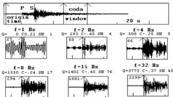
Рисунок 2 – Пример записи землетрясения и окна кода-волн и их представление на разных частотах [5]
