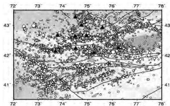
Рисунок 1 – Эпицентральное расположение локальных землетрясений (более 7000), зарегистрированных станциями сети KNET за 1994–2012 гг. Треугольниками отмечено расположение станций
