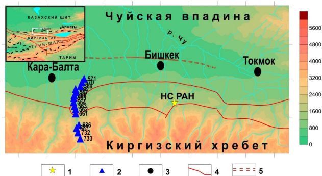
Рисунок 2 – Схема района работ: 1 – Научная станция РАН; 2 – пункты МТЗ; 3 – населенные пункты; 4 – разломные структуры; 5 – флексурно-разрывная зона
